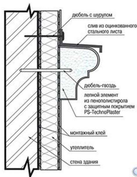
**Стыки между деталями заделываются только через 1–2 суток после окончательного приклеивания деталей к фасаду.**
