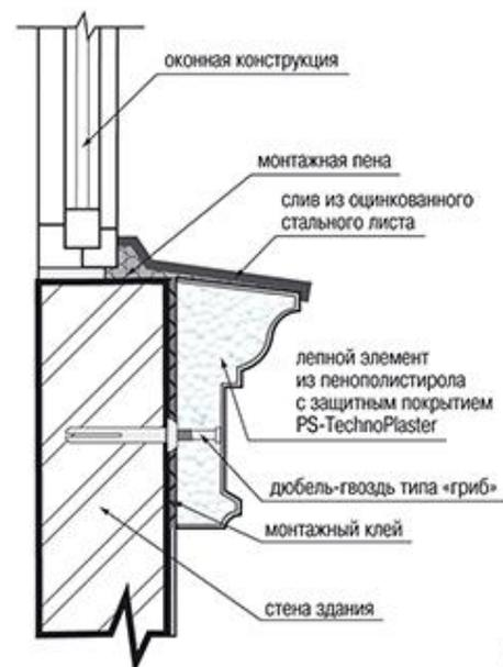
При таком дюбельном креплении также необходимо обеспечить надежный прижим детали к стене до тех пор, пока клей не схватится, – зафиксируйте деталь временными подпорками.
