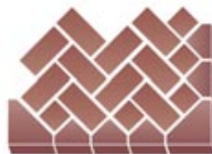
Verlegung mit Bischofsmützen
