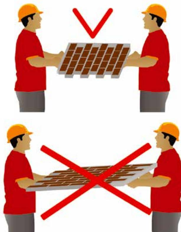
Рис. 31. Правильная и неправильная разгрузка термопанелей
