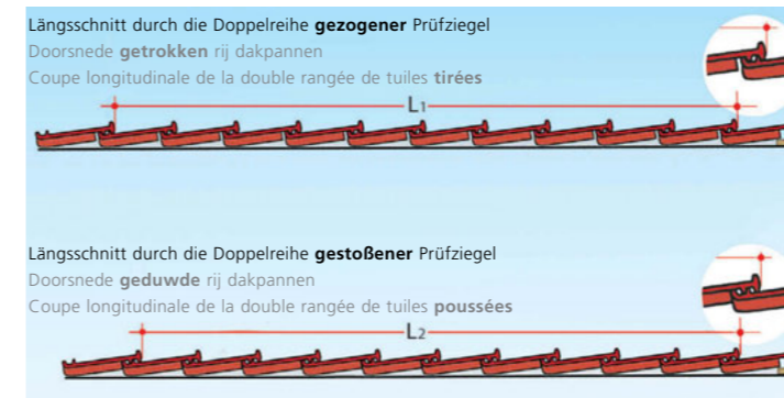
Orientierungs-Decklängen (cm) nach Anzahl der Flächenziegelreihen
